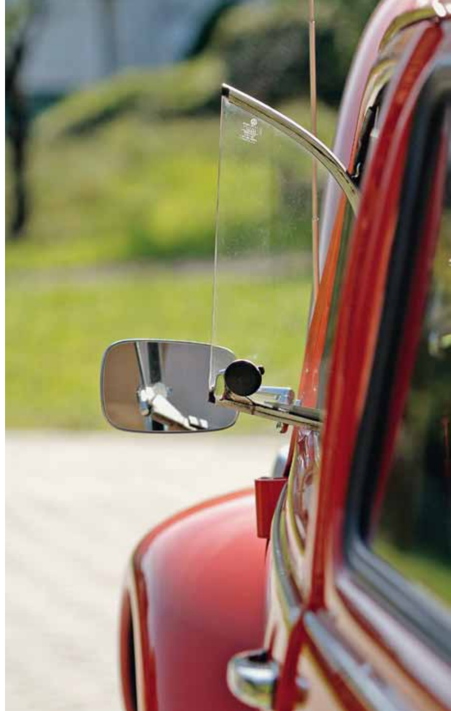
Das Ausstellfenster muss immer offen sein. Es sorgt für Frischluft während der Fahrt und für freie Sicht durch die Windschutzscheibe.
